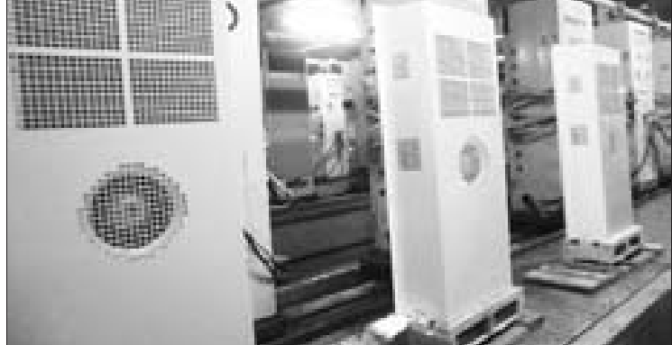
春兰空调设备有限公司首批DKC10W、DKC20W/F冷量的大功率机柜空调新品正在通过全自动检测线。 摄影/王道平
